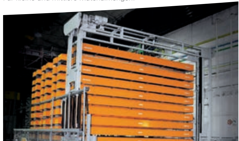
UNIPORTAL : Kassettenlager mit sehr guter Raumnutzung. Für kleine und mittlere Materialmengen.
