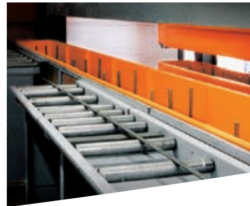
Über Rollenbahnen kann der UNITOWER an eine Säge angebunden werden.
