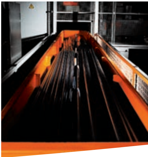
Längsstationen können am Boden oder in beliebiger Höhe eingebaut werden.
