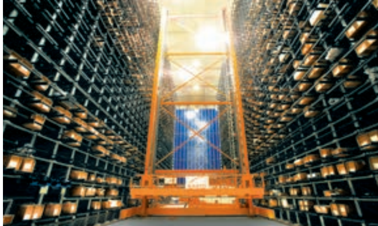
UNICOMPACT: kostengünstiges Waben-Langgutlager für mittlere bis große Lagervolumen.
