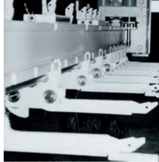
Die KASTO Lasttraverse VarioPlus erlaubt die Vereinzelung hintereinander liegender Einzelstäbe.
