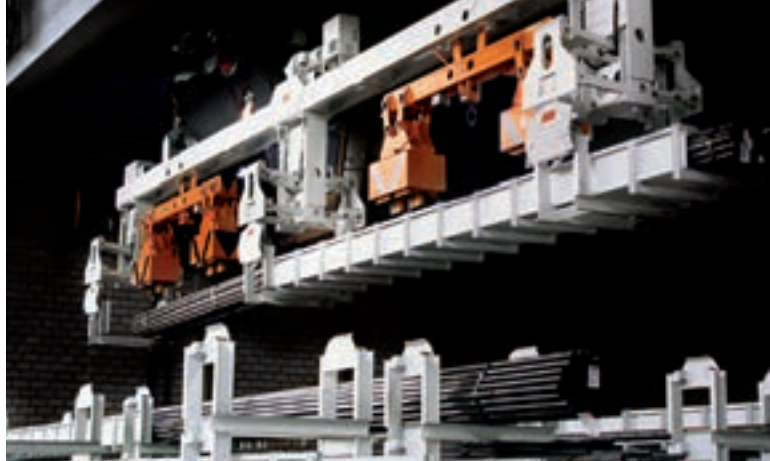
UNIBLOC F mit Kombi-Traverse zum wahlweisen Jochtransport und zur Stabentnahme.
