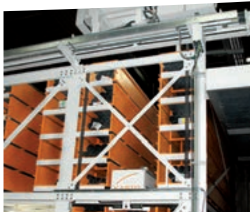
Überfahrlager UNITOP mit Tunnel für Transportwagen.
