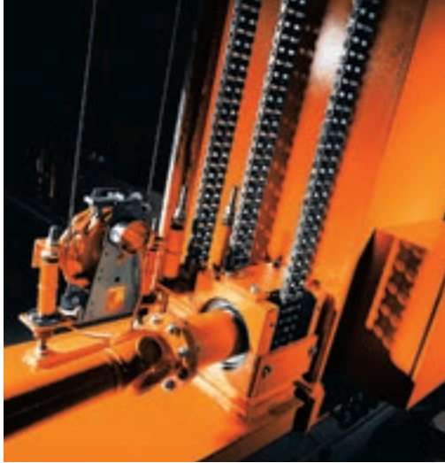
Wartungsarm und langlebig: Regalbediengerät mit Kettenhubwerk.
