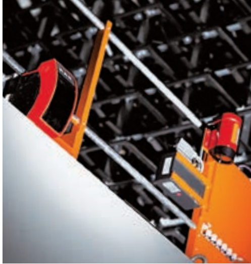
Datenlichtschranke und Laserachse sorgen für sichere Datenübertragung und störungsfreie Positionierung des Regalbediengerätes.
