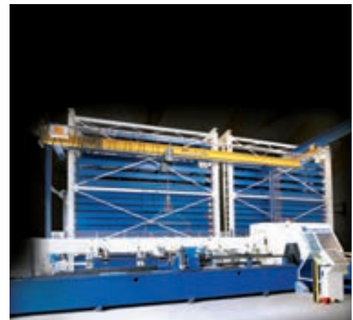
Doppelturm für Rohre als Vorratslager für eine Rohrlaserbearbeitungsmaschine.
