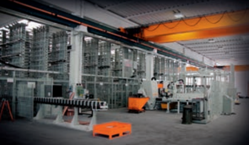
KASTOcenter: Kombiniertes Lager-Säge-System mit Markieren und Palettieren.
