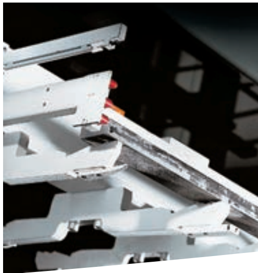
Die speziell geformte KASTO Lasttraverse entnimmt und transportiert jeweils genau eine Stange aus den Kragarm-Fächern.
