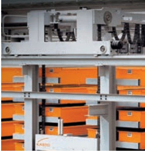
Das Kettenhubwerk des Regalbediengerätes: robust und langlebig.
