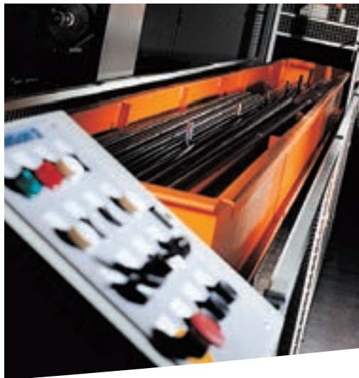
Ausfahren in Längsrichtung: Die Lasttraverse legt die Kassette auf ein Rollengerüst ab.
