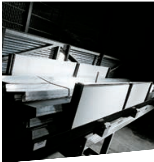
Einfach einhängbare Seitenwände für labiles oder empfindliches Material.
