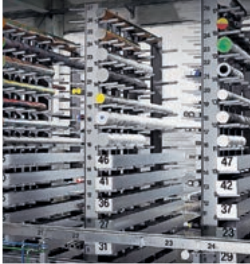
Für Einzelstäbe und Kassetten: KASTOcenter mit kombinierter Kassetten- und Kragarm-Lagerung.
