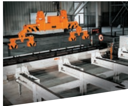
Magnetkran mit verspannter Seilführung zum schnellen Kommissionieren und Ablegen auf einem Abfuhr-Kettenförderer.
