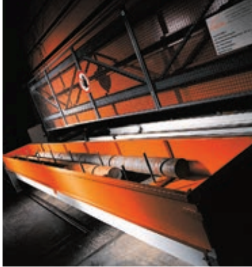
Für die einfache Be- und Entladung mit Seilschlaufen sind UNITOWER -Kassetten mit seitlichen Abstandsstegen ausgerüstet.
