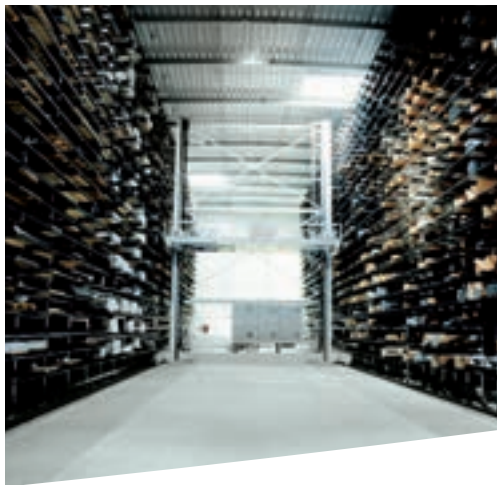
Wabenlager für Langgutkassetten und Blechpaletten.
