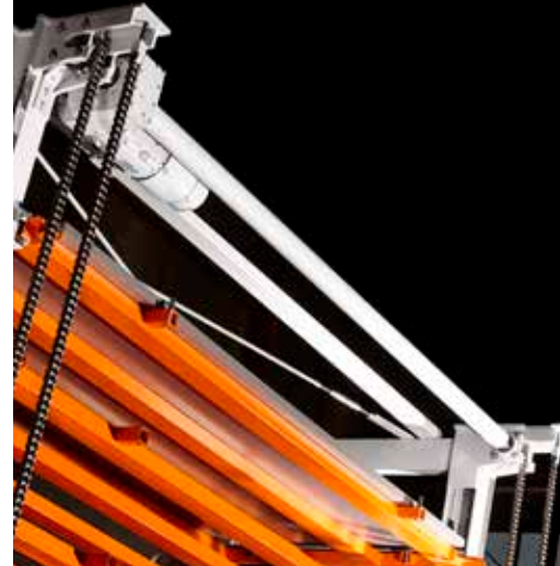
Stationärer Hubwerksantrieb mit Gleichlaufwelle.
