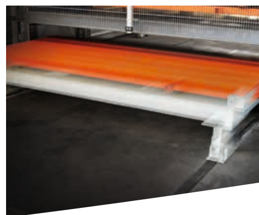
Manuell verschiebbarer Querwagen zur Beschickung auf der Lagerrückseite (Option).
